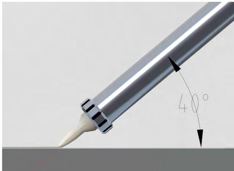
胶尺寸及标准用量：至少10\*5mm；5条/1片组件（胶沿着光伏组件宽度方向）；3条/1片组件（胶沿着光伏组件长度方向）
