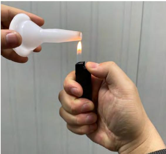
2、建议使用打火机加热胶嘴头部约 2s，防止其被压扁后回弹；
